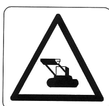
MÀQUINA PESANT EN MOVIMENT
