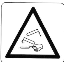
RISC DE CORROSIÓ
